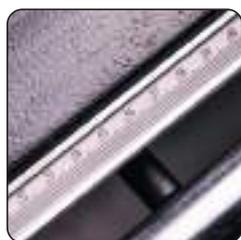
Guide de refente avec réglage micrométrique
